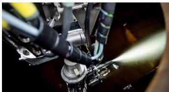
▲ Verstelbare spuitkop met inspectiecamera en verlichting
